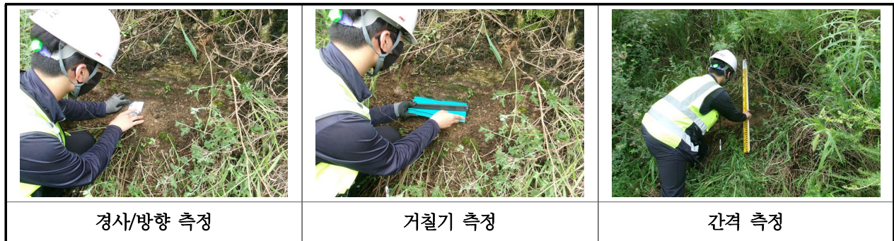
【사진 21.3.3】 불연속면 측정 현황
